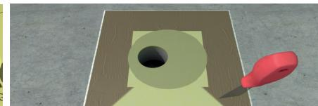
8. Prepara una primera unión entre las láminas con adhesivo SEAL PLUS.
