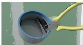
**1. IMPORTANTE:** comprobar si es necesario el sifón y cortarlo si es preciso.
